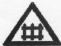
PASO A NIVEL DEL FERROCARRIL CON BARRERAS
