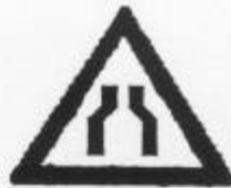
PUENTE ANGOSTO Se recomienda aminorar la marcha
