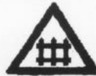
PASO A NIVEL DEL FERROCARRIL CON BARRERAS
