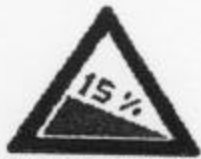
PENDIENTE PELIGROSA Se recomienda conectar segunda en el plan y descender con la compresión del motor frenado.
